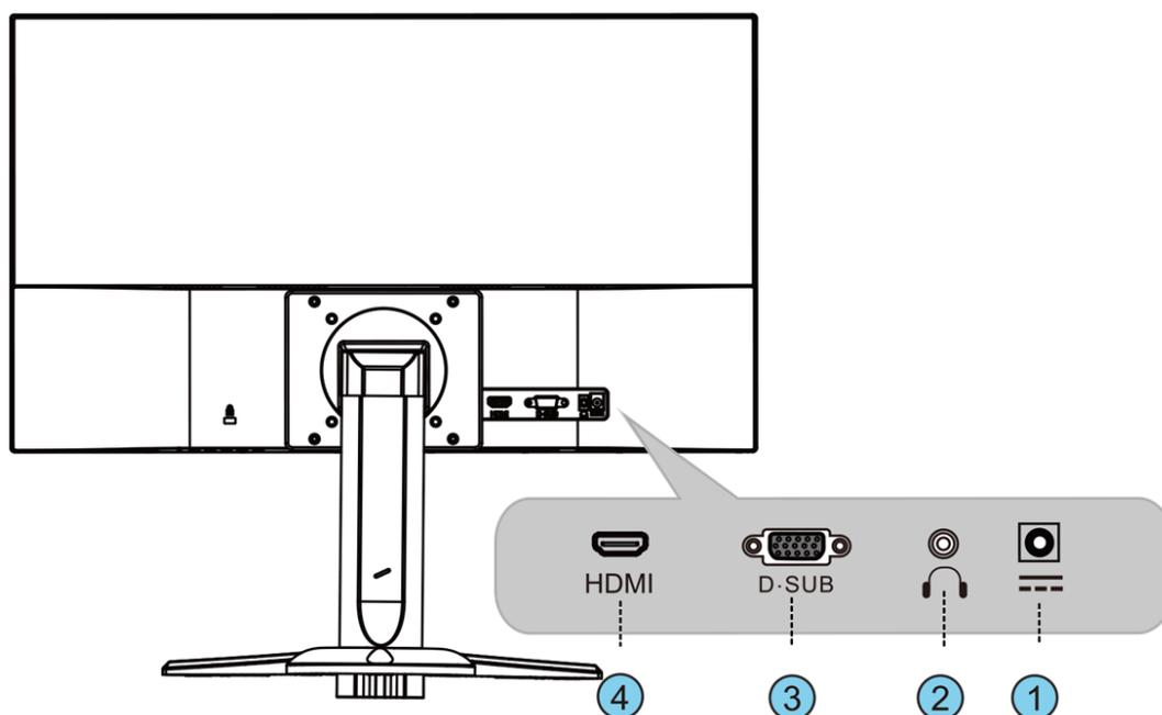
Figura 2. Conexión a un PC
