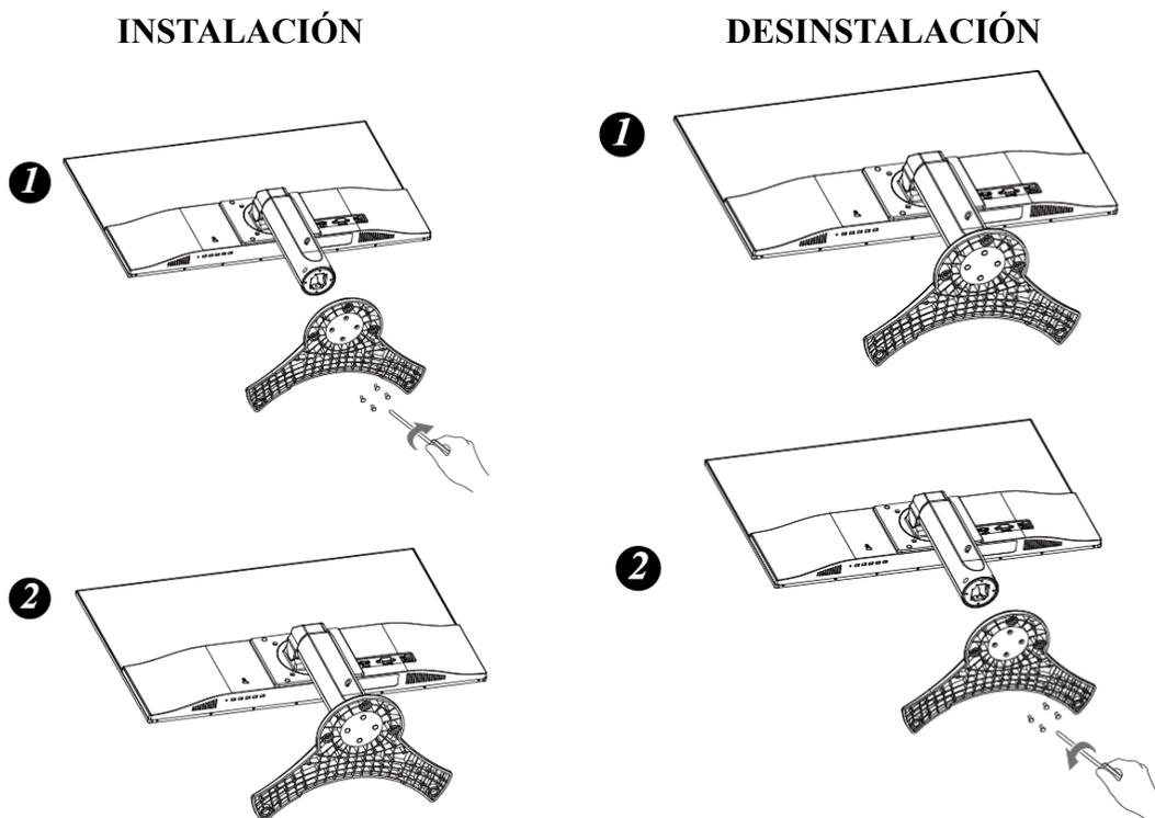
Figura 1. Instalar y desinstalar la base
